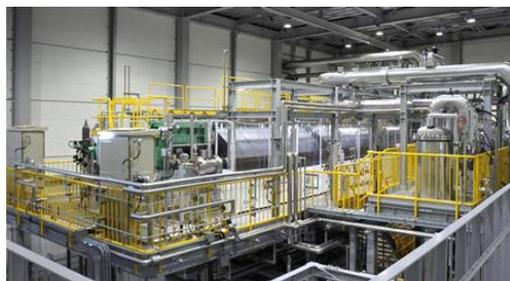
10MWの水電解装置
