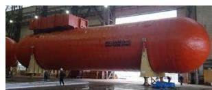
現在のLNG燃料タンク、燃料供給システム
